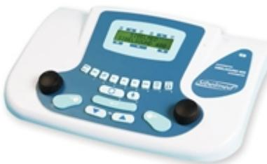
**Audiometri digitali a due canali, basati sull'elaborazione dei segnali digitali (DSP).**
