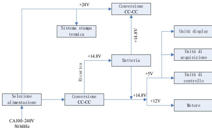
Figura 4-1 Diagramma a blocchi del principio di alimentazione
