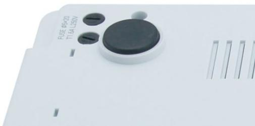
Figura 9-1 Sostituzione del fusibile
